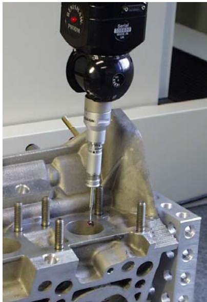
Bild 2. Digitalisierung des Auslasskanals eines Zylinderkopfs. Mit einem taktil, schwenkbarem Taster gelingt es, den Kanal mit unterschiedlichen Tasterstellungen im Gussteil zu erfassen.
