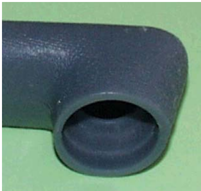
Bild 9. Das Rapid-Prototyping-Wachsmodell eines Bauteils wird auf der Basis von CAD-Daten erstellt
