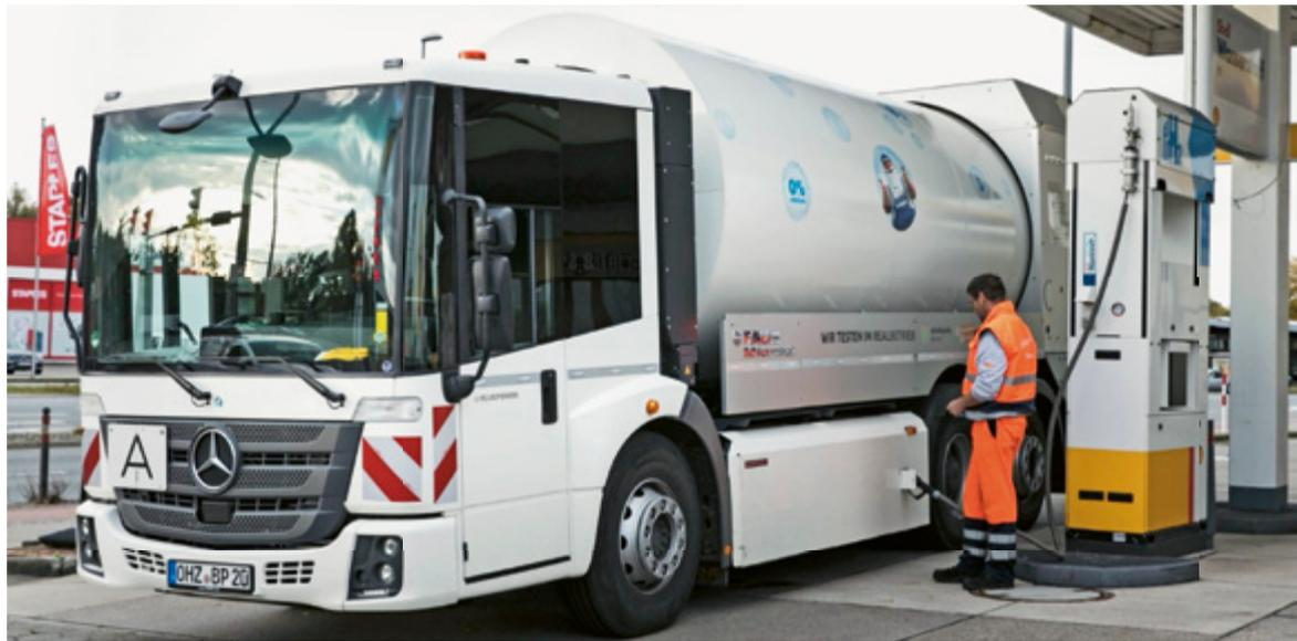
**BILD 5** Müllfahrzeug der Fa. Faun aus Osterholz Scharmbeck an einer Wasserstofftankstelle [7] (© Faun)
